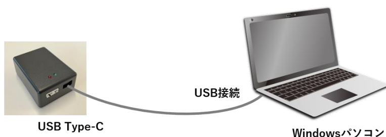
SpreadRouter-TW 設定する際の接続構成
